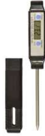
TEPLOMĚR VPICHOVÝ DIGITÁLNÍ 9204 Plastové držadlo, krytka použitelná jako prodloužení držadla. Kovový hrot 73 mm Rozsah měření: od -50 do +300°C. Obj.č.: 4467106200 Balení: 12 ks
