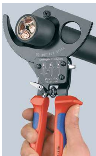
Princip rohátky se západkou a dvoustupňový pohon ozubeným věncem pro stříhání šetřící síly
