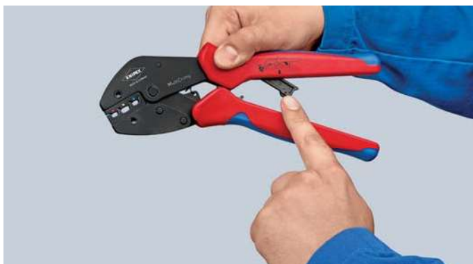
Sklopte servisní páku a promáčkněte kleště – jsou připraveny pro příští použití
