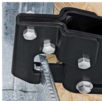
Nasazení kleští na dva spojované profilované plechy
