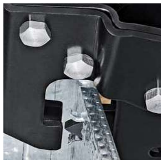
Lisovací nástroj je stlačován profilovanými plechy
