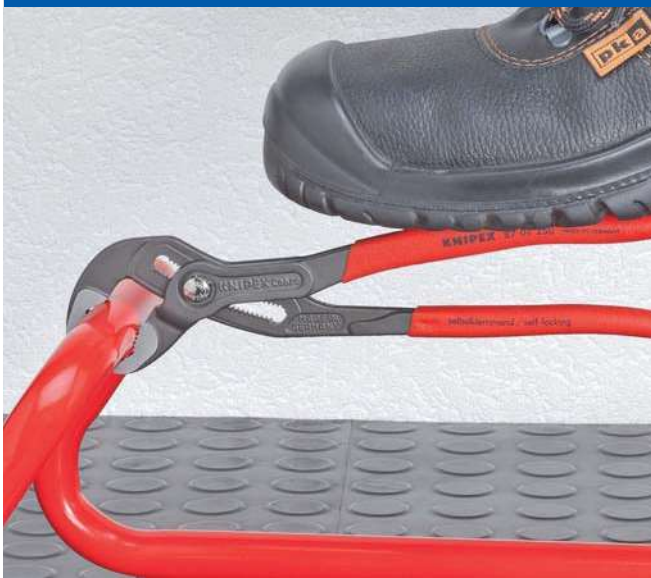
Zuby přesazené proti směru otáčení způsobují samosvorný efekt a zabráňují sklouznutí po obrobku.
