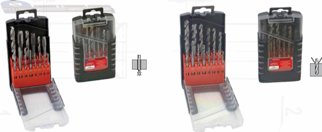
Sada vrtáků a závitníků 14-dílná v plastové krabičce Set of 14 drills and taps in plastic box 14-teiliger Spiralbohrer und Gewindebohrer in Plastikkasten 338RTIHSSCo5 Ø 2,5; 3,3; 4,2; 5,0; 6,8; 8,5; 10,2 mm DIN371(173) M3; M4; M5; M6; M8; M10 + DIN376(183) M12 s lamačem HSSE (Co5) / with spiral point HSSE (Co5) / mit HSS-Brecher HSSE (Co5)
